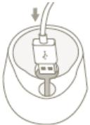
1. Inserte el extremo USB del cargador Plink en el agujero en el centro de la base
